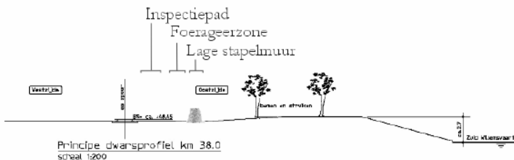
Figuur 16. Voorbeeld van een dwarsprofiel van het spoor met een lage stapelmuur in de berm
